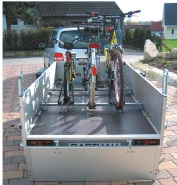
Einfache Befestigung der Lastenträger am Ladungssicherungssystem **TOPZURR24**.
