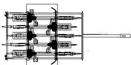
Lastenträger für alle Kastenanhänger von 1060mm bis 1560mm Kasteninnenbreite mit Multiplexbordwand. Es können darauf Kanus, Fahrradständer und vieles andere problemlos transportiert werden. Mit wenigen Handgriffen ist der Träger leicht zu entfernen. Die Aufnahmeschienen für die Pratzen bleiben fest mit der Bordwand verschraubt, sie stören nicht. Sogar eine Flachplane kann unter dem Lastenträger befestigt werden.
